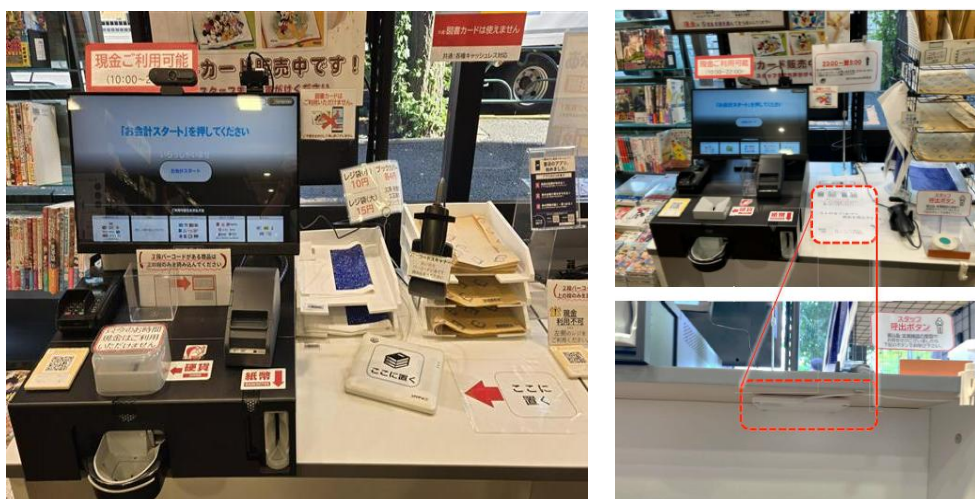
図7 RFID 卓上 RW のレジ台卓上設置図（左）とレジ台天板裏設置（右）
